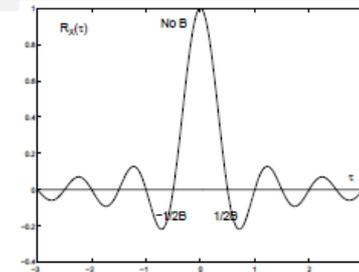
Le bruit blanc continu n'a pas de réalité physique. Un bruit physique pourra être considéré comme étant un bruit « blanc » si sa d.s.p. est constante dans une bande de fréquence suffisamment large pour couvrir une bande passante du système de traitement du signal. Un tel bruit est forcément corrélé.
